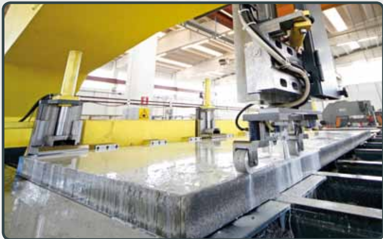
Munkatartomány: 8000x2000 mm Vágható maximális vastagság: 200 mm Vágható idomok: hasábok
