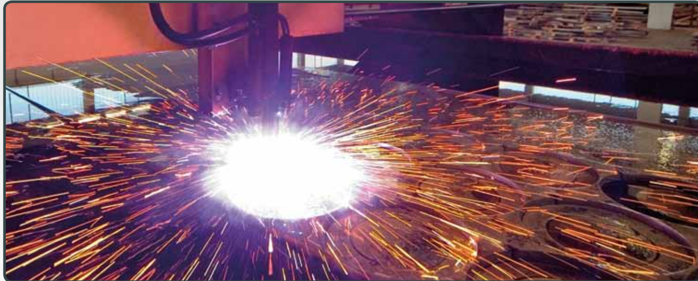
Munkatartomány: 8000x3000 mm Vágható maximális vastagság: 150 mm Vágható idomok: tárcsák, karimák, hasábok, rajz szerinti alakzatok
